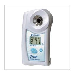
Карманный цифровой измеритель влажности PAL-Moisture предназначен для быстрой оценки содержания воды в продукте.
