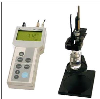
рН-метр-милливольтметр рН-150МА предназначен для измерения значений рН, окислительно-восстановительного потенциала (Еh) и температуры в технологических и других водных растворах, природных и сточных водах.
