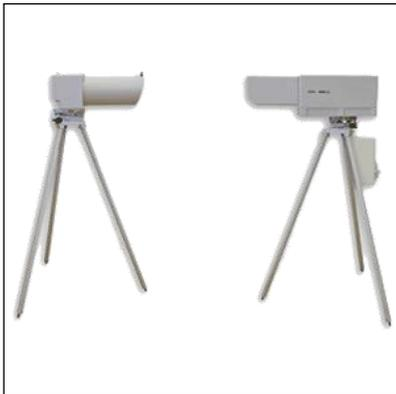
**Измеритель дальности видимости ФИ-3** предназначен для непрерывного дистанционного измерения и регистрации светового коэффициента направленного пропускания (СКНП) атмосферы в месте установки и вычисление по значению СКНП метеорологической (оптической) дальности видимости (МОД).
