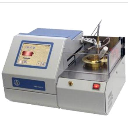
Автоматический аппарат ТВО-ЛАБ-12 предназначен для определения температуры вспышки в открытом тигле по методу Кливленда, в соответствии с ГОСТ 4333-87, ISO 2592, ASTM D 92 при температурах до +400°C.
