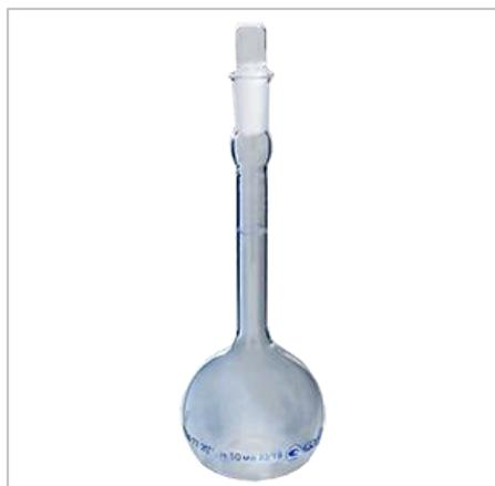
Применяются при определении плотности вещества в жидком состоянии. Принцип действия основан на взвешивании веществ, заполняющих пикнометр до метки на горловине, что соответствует номинальной вместимости пикнометра.
