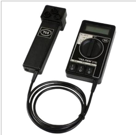
ТКА-ПКМ-13 предназначен для отдельного измерения энергетической освещенности в областях УФ-спектра:
