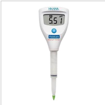
HI-981036 разработан, чтобы максимально упростить процедуру измерения pH в мясе. Такие особенности встроенного электрода как открытая диафрагма, коническая мембрана и съемный пластиковый рукав позволяют проводить измерения в мясе напрямую, минуя длительную и трудоемкую процедуру пробоподготовки, включающую экстракцию образца в дистиллят и фильтрование.
