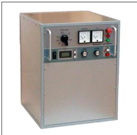
Установка АПК 14/7000 предназначена для преобразования высокоомных повреждений в низкоомные путем прожига дефектного места изоляции большим током.
