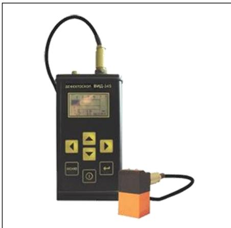
Магнитно-вихретоковый дефектоскоп ВИД-345 предназначен для выявления и определения глубины стресс-коррозионных трещин в ферромагнитных конструкциях, в т. ч. под слоем изоляционного покрытия и/или коррозии, а так же для контроля толщины изоляционного покрытия на контролируемом изделии.
