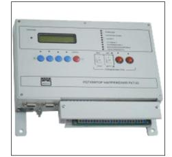
Микропроцессорный регулятор напряжения трансформаторов (РКТ.02) предназначен для управления электроприводами устройства регулирования напряжения под нагрузкой (РПН) при автоматическом регулировании коэффициента трансформации силовых трансформаторов с целью стабилизации напряжения на шинах подстанции или у потребителя.
