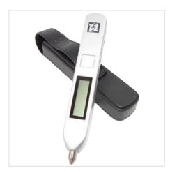
Виброметр TV-200 предназначен для измерения периодических колебаний, частности вращающихся возвратно-И поступательных механизмов. Используется для измерения вибрации машинного оборудования и быстрой проверки состояния подшипников и шестерен.
