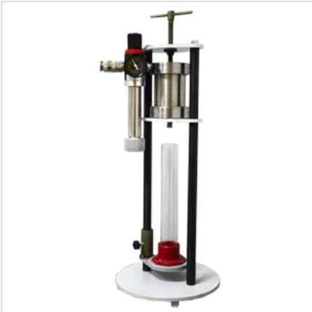
Фильтр-пресс ФЛР-2 применяют для оперативного определения фильтрата отдачи бурового раствора в полевых и стационарных условиях.
