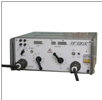
Прибор **Исток** предназначен для испытания, наладки и проверки автоматических выключателей и релейных защит при токе до 12 кА.
