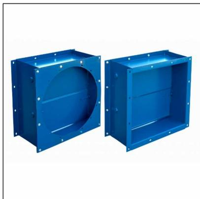
Клапан лепестковый устанавливается на нагнетательной стороне осевых вентиляторов типа ВО для предотвращения попадания холодного воздуха и атмосферных осадков в производственные помещения после отключения вентиляторов.
