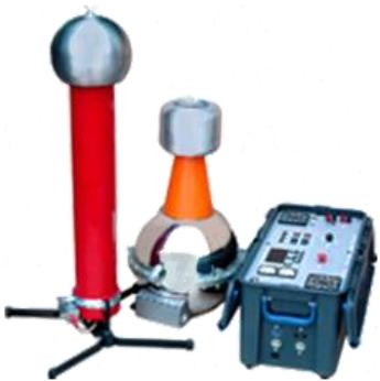
Переносные установки УИВ предназначены для испытаний изоляции электрооборудования высоким напряжением промышленной частоты 50 Гц.
