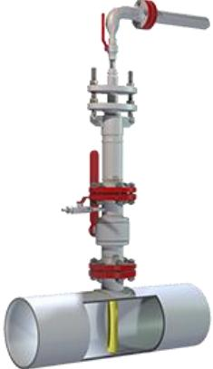
Пробозаборные устройства ЩПУ-1 предназначены для отбора высокопредставительной пробы любой жидкости или газожидкостной или газовой среды из трубопроводов, а также осуществления монтажа или осмотра устройства при наличии избыточного давления в трубопроводе; позволяют спроектировать и обеспечить оптимальные режимы работы УУ, в т.ч. СИКН(С), и ручного отбора пробы.
