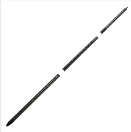
Пробоотборник глубинный всасывающий электронный ПГВсЭ-30-38 предназначен для отбора глубинных проб пластовой жидкости из скважины, обсаженной лифтовыми и насосно-компрессорными трубами, а также обсадными колоннами с рабочим давлением не более 30 МПа и температурой до 125°С, в том числе из скважины оснащенной струйным насосом.
