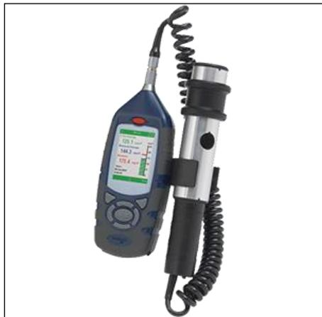
CEL-712 Microdust Pro – портативный прибор для измерения массовой концентрации пыли. Является прочным и надёжным прибором для регистрации данных массовой концентрации пыли в воздухе в режиме реального времени.
