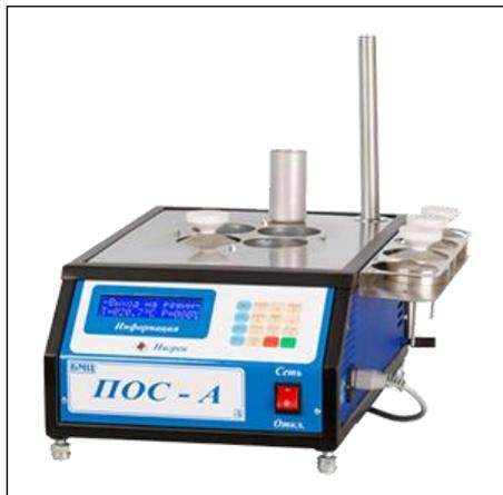
Устройство предназначено для измерения и поддержания температуры при определении концентрации фактических смол в моторном топливе (керосине, дизельном топливе) в соответствии с ГОСТ 8489-85.
