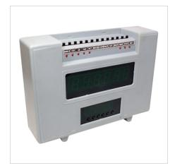
Секундомер СТЦ-2М предназначен для измерения интервалов времени, счета числа импульсов, а также формирования на таймерном выходе управляющего сигнала по истечении заданного интервала времени или по достижении заданного числа импульсов, или последовательности импульсов постоянного тока с устанавливаемым оператором значением периода.
