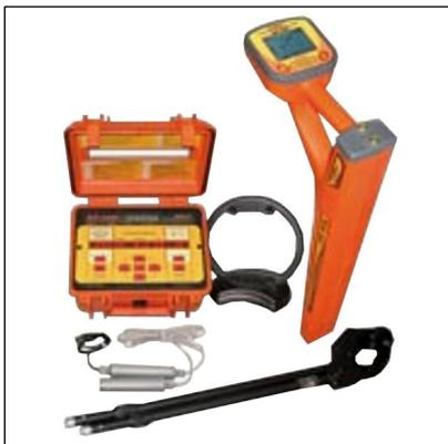
Кабелетрассопоисковый комплект **Атлет АГ-319СКИ** предназначен для нахождения места и глубины залегания подземных коммуникаций (силовых и сигнальных кабелей, трубопроводов) на глубине не более 10 м и удалении до 10 км от места подключения генератора.
