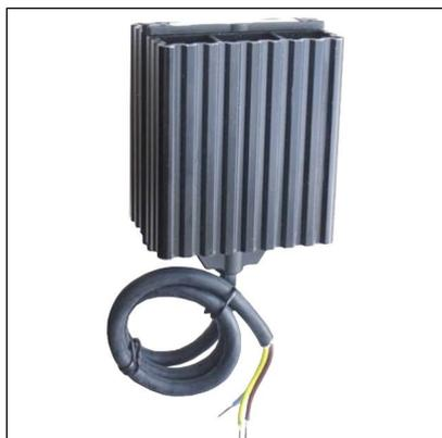
Позисторный PTC нагреватель **DMK** устанавливается на DIN рейку. Нагреватель DMK предназначен для предотвращения образования конденсата и понижения температуры ниже указанного минимума. В этом случае нагреватель должен последовательно соединяться с термостатом.
