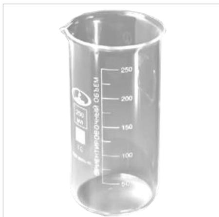
Стаканы мерные В-1 предназначены для фильтрования, выпаривания и приготовления растворов в лабораторных условиях.
