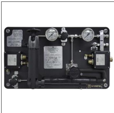
Блок редуцирования «Model-001» предназначен для редуцирования и обогрева пробы газа с рабочего давления до давления в диапазоне от 0,03 до 3,5 МПа. Обогрев пробы газа обеспечивает предотвращение возможной конденсации при охлаждении газа в процессе редуцирования.
