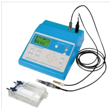
Амперометрический канал прибора, совместно с амперометрическим сенсором парциального давления кислорода АСрО<sub>2</sub> НЖЮК 943119.001-01, предназначен для измерения концентраций растворённого в воде кислорода. Конструкция входного каскада ориентирована на работу с АСрО<sub>2</sub> повышенной чувствительности (от 2 мкг/дм<sup>3</sup>).
