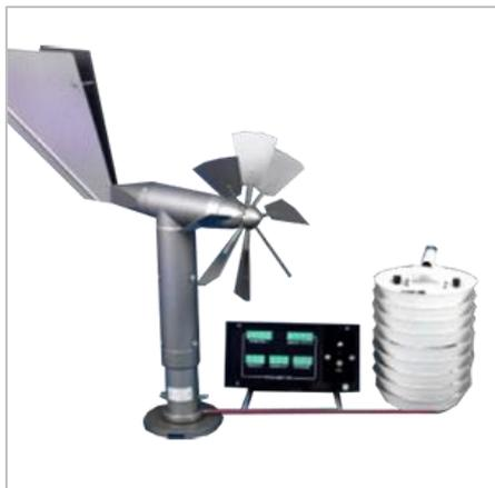
Метеостанция М-49М с датчиком ветра М-127 предназначена для дистанционного измерения скорости и направления ветра, атмосферного давления, температуры и относительной влажности воздуха.
