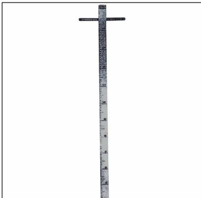
М-46 рейка снегомерная металлическая переносная применяется для измерения высоты снежного покрова при производстве снегомерных съемок.
