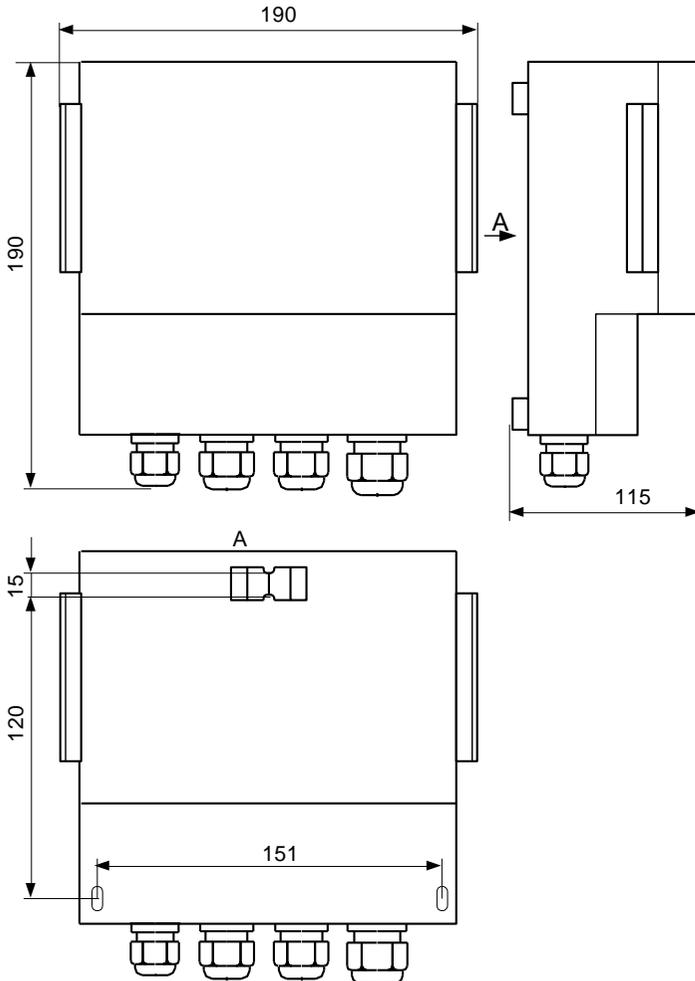
**ЭСКИЗ МОНТАЖА АКУСТИЧЕСКОГО ПРЕОБРАЗОВАТЕЛЯ АП-11
