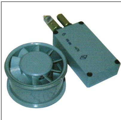
Осевые электровентиляторы постоянного тока **0,5ЭВ-0,7-20-4620** предназначены для охлаждения блоков электронной аппаратуры. Вентиляторы состоят из приводного асинхронного двигателя с внешним ротором и блока питания. Блок питания представляет собой статический преобразователь постоянного тока в переменный.
