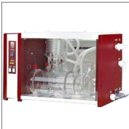
Полностью автоматический аппарат для двойной дистилляции воды, подходит как для настольного, так и настенного размещения. Дистилляторы GFL используются в исследовательских лабораториях, например при подготовке медицинских и бактериологических образцов, культур клеток и тканей, а также при приготовлении реагентов. Кроме этого, получаемый дистиллят используется для процессов очистки и стерилизации, при приготовлении буферных растворов, а также в аналитических целях.
