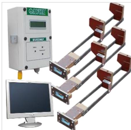
Влагомер Фауна-ПМДРЗ предназначен для измерения массовой доли влаги (влажности) и температуры в потоке зерновых или масличных культур в одной точке измерения.
