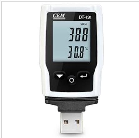
Регистратор температуры и влажности DT-191A позволяет проводить мониторинг температуры и влажности, используется в качестве регистратора температуры за определенный период времени.
