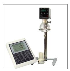
Лабораторный солемер нефти «САН-Л» предназначен для измерения солесодержания проб нефти, отобранных:
