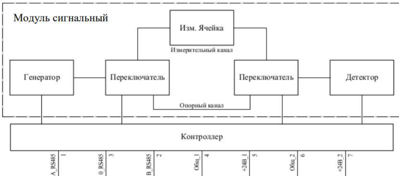
Рис. 3. Функциональная схема первичного преобразователя
