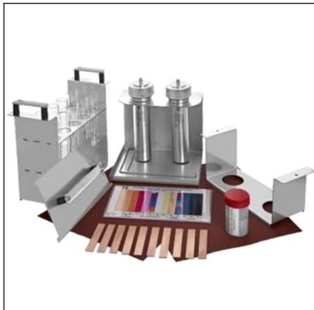
Комплект приспособлений для проведения испытаний на медной пластинке
