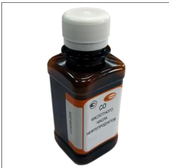
Стандартный образец предназначен для аттестации и контроля погрешностей методик выполнения измерений кислотного числа нефтепродуктов методом кислотно-основного титрования в неводных средах по ГОСТ 5985-79, ГОСТ 11362-96, ИСО 6619-88.
