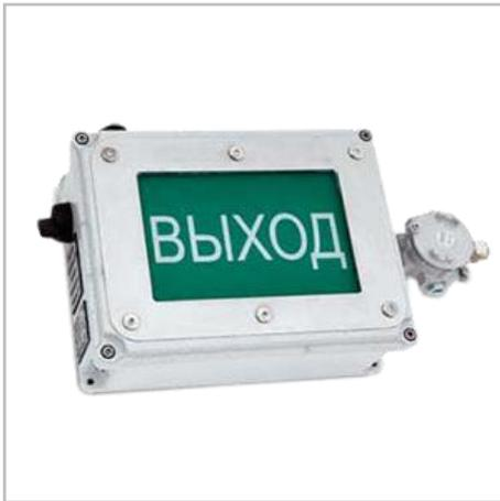
Взрывозащищенное светодиодное табло ПГС-ИТ33 применяется в качестве информационного указателя, для выдачи сигналов светового оповещения внутри помещений и на открытых промышленных площадках во взрывоопасных зонах, в присутствии взрывоопасных и воспламеняемых газов и пыли, с целью регулирования поведения человека как в штатном режиме, так и при возникновении чрезвычайных ситуаций.
