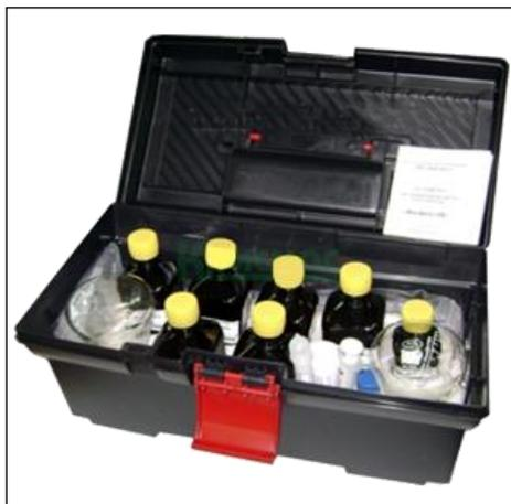
Тест-комплект Фосфаты-КВ предназначен для экспресс-определения содержания фосфатов в пресных технических водах - исходных, сетевых, подпиточных, питательных, в их конденсатах, а также в котловых, циркулирующих в системах охлаждения и теплофикационных водах (РД 24.032.01-91).
