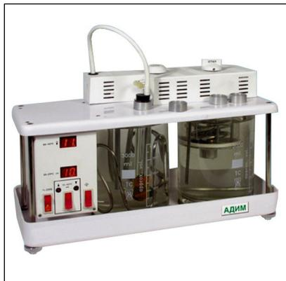
Аппарат **АДИМ** предназначен для определения качества и возможности дальнейшей эксплуатации нефтяных турбинных масел по показателю “время деэмульсации” (ГОСТ 2068-66). Регулярный контроль времени деэмульсации нефтяных масел существенно увеличивает срок эксплуатации энергетического оборудования, и более эффективно использовать деэмульгирующие присадки.
