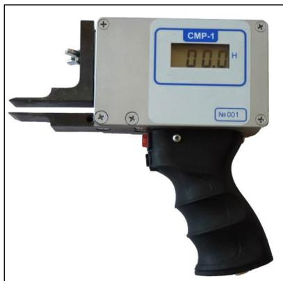
Измеритель силы контактного нажатия ламелей **СМР-1** предназначен для измерения усилия нажатия в отдельной паре ламелей контактов врубного типа отключенных разъединителей 10...750 кВ и ячеек КРУ 6...10 кВ согласно п. 14.4 П, С РД 34.45-51.300-97 «Объем и нормы испытаний электрооборудования». Измеритель также может применяться при регулировке усилия нажатия разъединителей.
