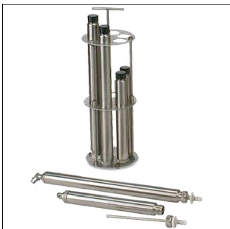
Пробоотборник RNS 502 разработан для взятия пробы, дающей информацию обо всем содержимом резервуара. Он постепенно заполняется жидкостью во время спуска от поверхности ко дну резервуара.
