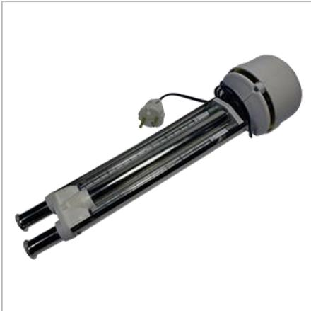
Психрометр М-34М предназначен для определения относительной влажности и температуры воздуха в наземных условиях в помещениях и на открытом воздухе.
