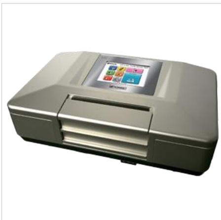
Поляриметры автоматические SAC-i предназначены для измерения угла вращения плоскости поляризации монохроматического излучения при его прохождении через оптически активные вещества (водные растворы сахарозы, аскорбиновая кислота, глутамат натрия, кварцевые пластинки) с одновременным измерением температуры образца.
