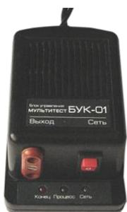
**БУК-01 блок управления Мультитест** является промежуточным преобразователем выходного сигнала релейного выхода титратора.
