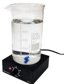
**Магнитная мешалка Мультитест ПС-11** предназначена для перемешивания жидкостей в лабораторных условиях.
