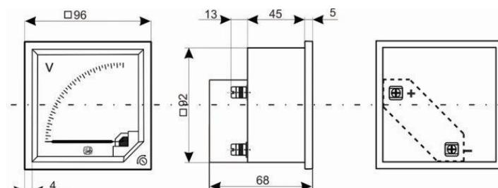
Габаритные размеры щитовых аналоговых амперметров и вольтметров М311-4.
