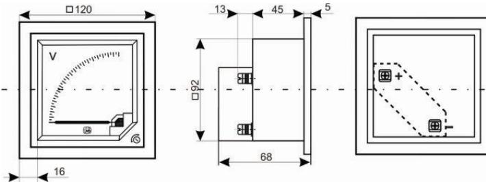
Габаритные размеры щитовых аналоговых амперметров и вольтметров М311-3 (120x120).
