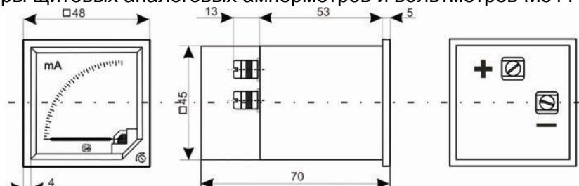
Габаритные размеры щитовых аналоговых амперметров и вольтметров M311-2.
