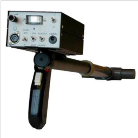
Приёмник ПСП-2-4 представляет собой высокочувствительный селективный усилитель, который может работать как в узкополосном, так и в широкополосном режимах. Принимаемый сигнал регистрируется стрелочным индикатором, а также с помощью световой и звуковой сигнализации или на слух через микротелефонную гарнитуру.
