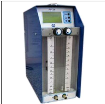
Предназначен для автоматического отбора проб воздуха и аэрозолей (в рабочей зоне, атмосфере и промышленных выбросах) при проведении санитарного и экологического контроля. Аспиратор обеспечивает отбор проб с заданным объемным расходом через любые типы поглотителей по двум параллельным каналам (0,5 - 5 л/мин, 2 - 20 л/мин). Отобранные пробы анализируются в лабораторных условиях с применением стандартных методик.
