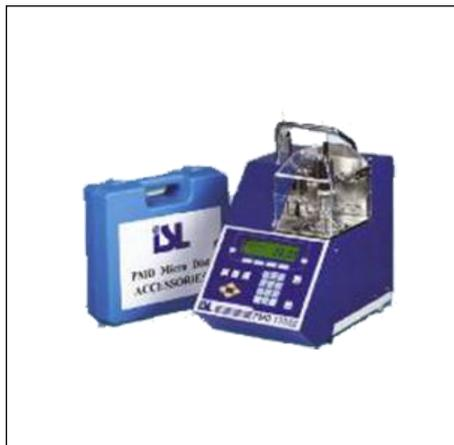
Компактный автоматический экспресс-анализатор с высокой точностью обеспечивает определение фракционного состава нефтепродуктов. С помощью аппарата PMD 110 за 10 минут с использованием всего 10 мл пробы стало возможным получить кривую разгонки, идентичную ASTM D86, ГОСТ 2177.
