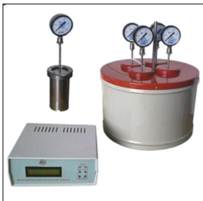
Аппарат предназначен для обеспечения проведения испытания в соответствии с методикой, изложенной в ГОСТ 11802-66.
