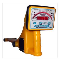
Абрис-24.20 состоит из генератора ТГ-24.20 и приемника ТМ-8.
